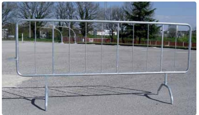
**Fig. 2401** dimensioni 110x250 cm., tubolare Ø 32 mm., con nr. 7 tondini Ø 8 mm., nr. 3 tubolari quadri 15x15 mm., per eventuale applicazione pannello rifrangente b/r cl.1 20x150 cm.
