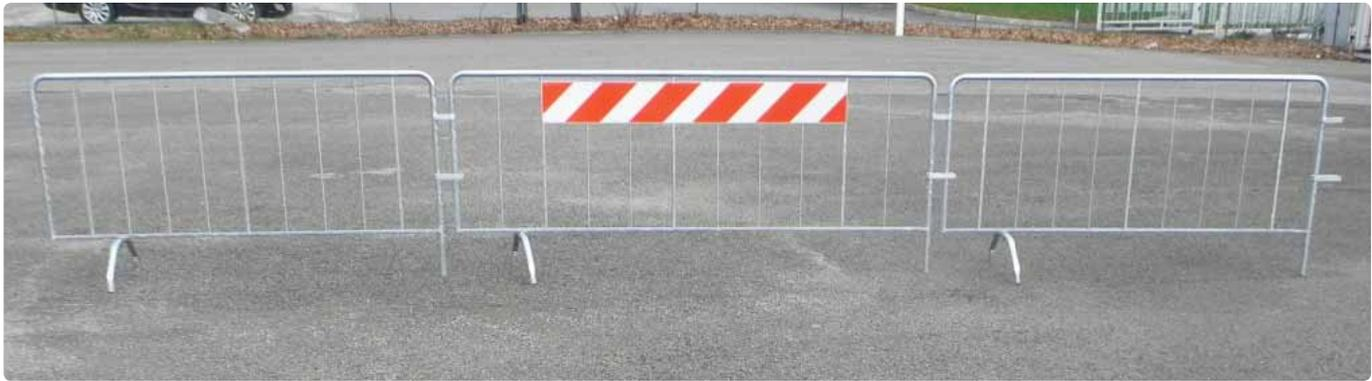
**Fig. 2400/M** dimensioni 100x200 cm., tubolare Ø 32 mm., con nr. 6 tondini Ø 8 mm., nr. 3 tubolari quadri 15x15 mm., per eventuale applicazione pannello rifrangente b/r cl.1 20x150 cm.
