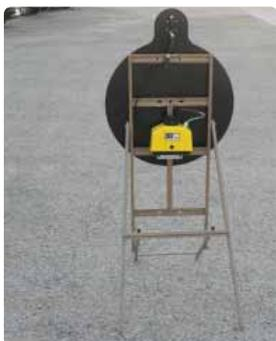
Realizzato in materiale VTR disco Ø 60 cm., rifrangenza cl. 2 prismatica, con lampada multiled 100 omologata cl. L2H e certificata “CE” o led M200 omologata cl. L8H e certificata “CE” a luce lampeggiante gialla, completo di cavalletto e pacco batterie (batterie escluse).
