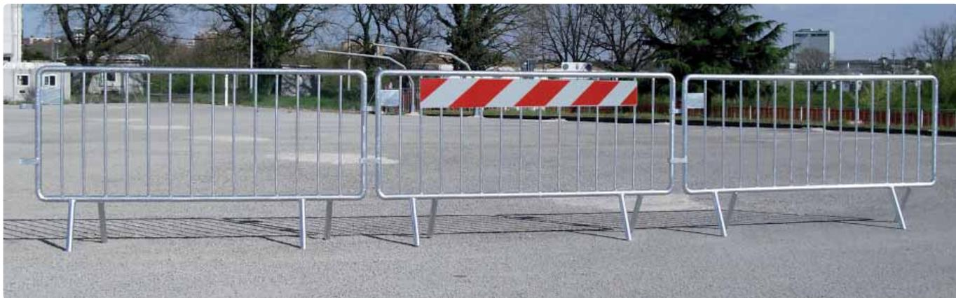
**Fig. 2400/E** dimensioni 110x200 cm., tubolare Ø 32 mm., con nr. 12 tondini Ø 8 mm., nr. 3 tubolari quadri 15x15 mm., per eventuale applicazione pannello rifrangente b/r cl.1 20x150 cm.
