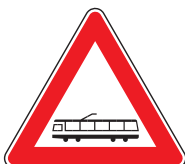
FIG. 12 ART. 88 ATTRAVERSAMENTO TRAMVIARIO
