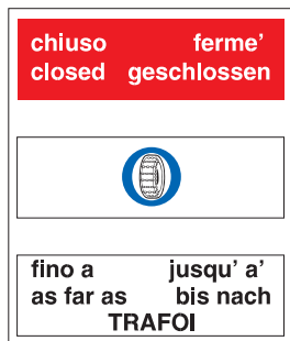
FIG. 335 ART. 135 TRATTO TERMINALE DELLA STRADA O PASSO CHIUSO
