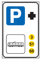
FIG.369 ART.136 PARCHEGGIO DI SCAMBIO CON TRAM
