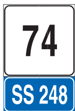
FIG. 266 ART. 129 PROGRESSIVA DISTANZIOMETRICA PER STRADA STATALE
