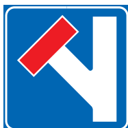
FIG. 310 ART. 135 PREAVVISO DI STRADA SENZA USCITA
