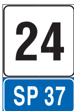
FIG. 267 ART. 129 PROGRESSIVA DISTANZIOMETRICA PER STRADA PROVINCIALE
