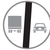
FIG. 73 ART. 119 FINE DEL DIVIETO DI SORPASSO PER I VEICOLI DI MASSA A PIENO CARICO SUPERIORE A 3,5 TON.
