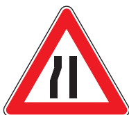
FIG. 18 ART. 90 STRETTOIA ASIMMETRICA A SINISTRA
